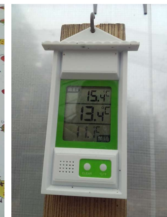
Le thermomètre Mini maxi nous donne la température immédiate ainsi que la plus chaude, la plus froide.
