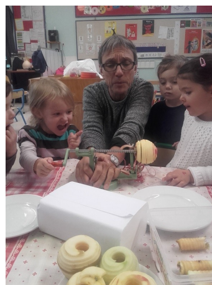
La pomme, enfoncée sur les dents du pèle-pomme, tourne et avance grâce à une grande vis. Puis le rasoir épluche la pomme. Enfin un système évite le trognon. BRAVO Anaïs
