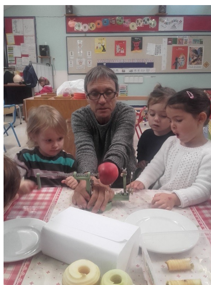
La pomme, enfoncée sur les dents du pèle-pomme, tourne et avance grâce à une grande vis. Puis le rasoir épluche la pomme. Enfin un système évite le trognon. BRAVO Anaïs
