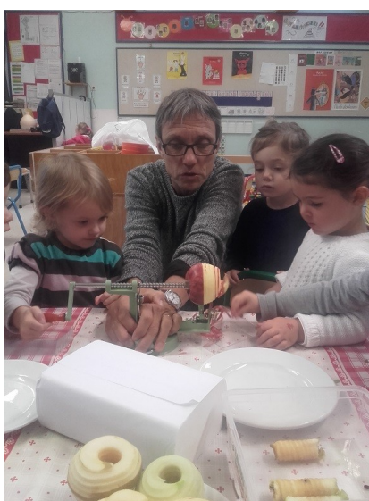
La pomme, enfoncée sur les dents du pèle-pomme, tourne et avance grâce à une grande vis. Puis le rasoir épluche la pomme. Enfin un système évite le trognon. BRAVO Anaïs
